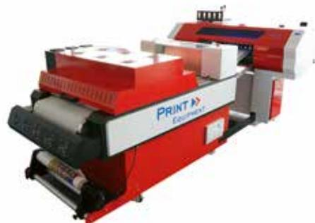
Ein Drucksystem für Rollenware besteht in der Regel aus einem Drucker (rechts hinten) sowie einer Fixiereinheit (vorne).
