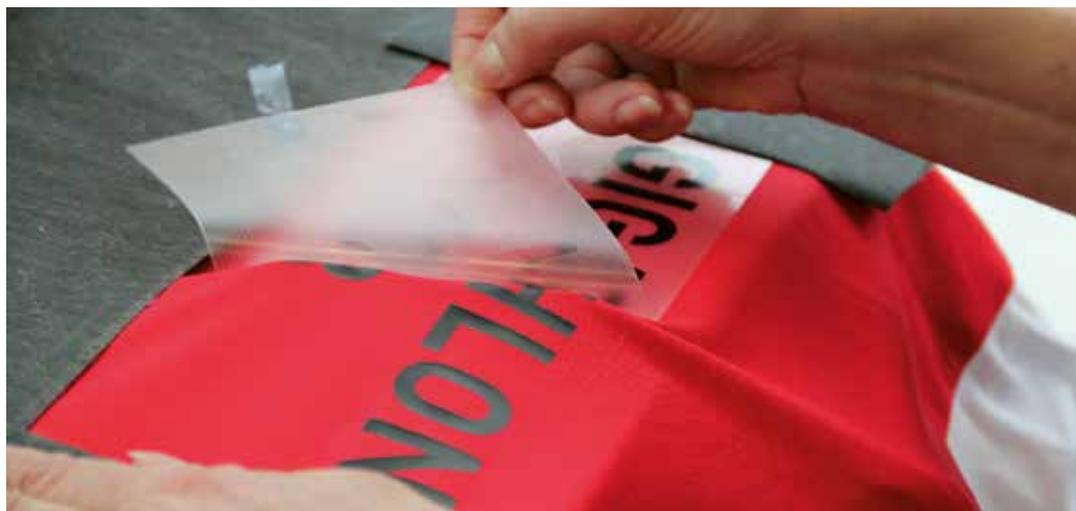
Für eine optimale Haftung der Textildrucktransfers sollten die Vorgaben der Hersteller wie Applikationstemperatur, Anpressdruck und Zeit eingehalten werden. (Foto: Stefan Meyer)
