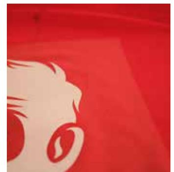
Sichtbarer Plattenabdruck auf dem Textil nach dem Transfervorgang.
