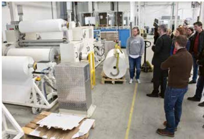
An dieser Maschine werden einzelne Folienschichten miteinander verbunden.
