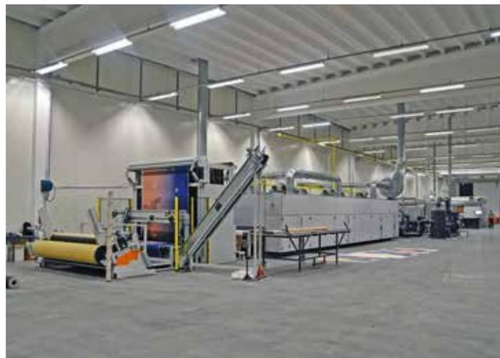
Die Drucklinie ist insgesamt 56 Meter lang. (Fotos: PhotoFabrics GmbH)
